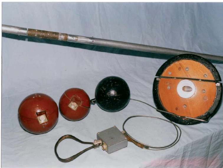
Рис. 8. Внешний вид тензометрических легкоатлетических снарядов
