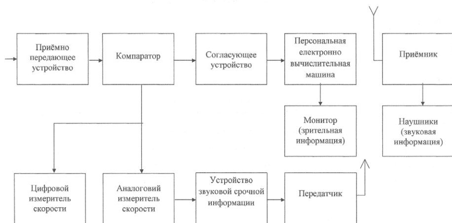
Рис. 20. Функциональная схема радиолокационной системы регистрации скорости бега со звуковой и зрительной срочной информацией
