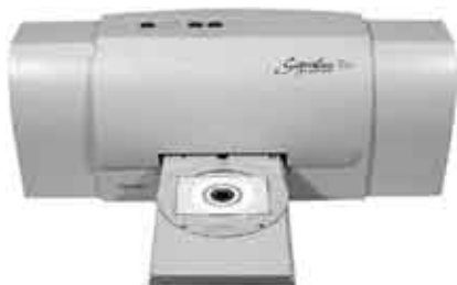
Рис. 3. Повнокольоровий струминний принтер для друку на CD/DVD дисках. (Primera Signature PRO; 2400x1200 dpi)
