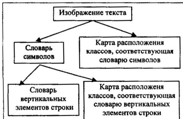
Рис. 11. Схема двухэтапной обработки изображения текста алгоритмом ИЛЛ2
