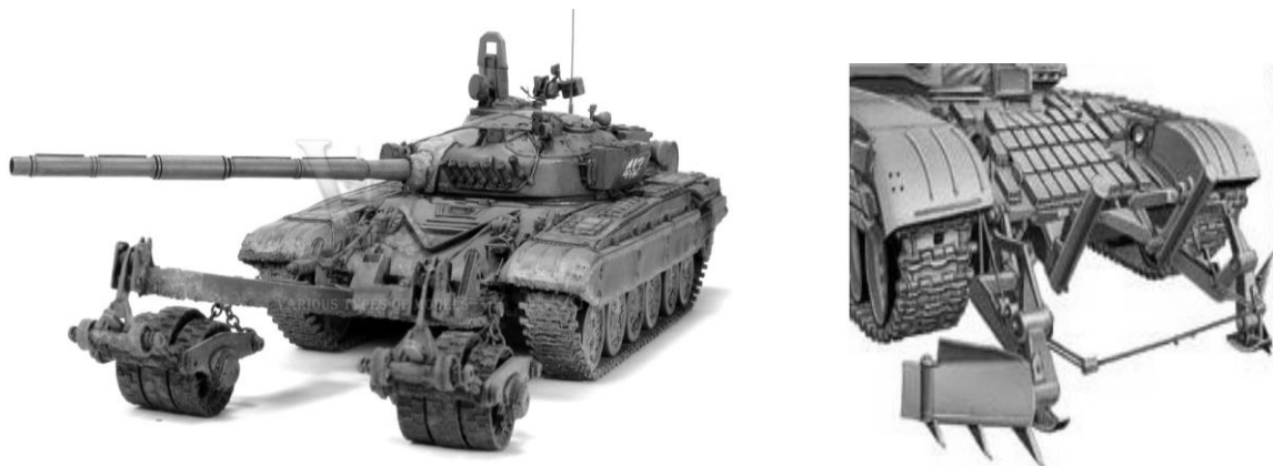
Рис. 68. Мінні трали: а – мінний трал КМТ-7, б – мінний трал КМТ-8
