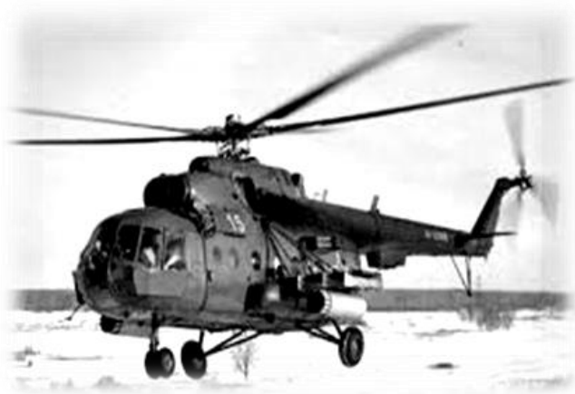
Рис. 49. Вертоліт Мі – 8МТ з розкладником ВМР – 2
