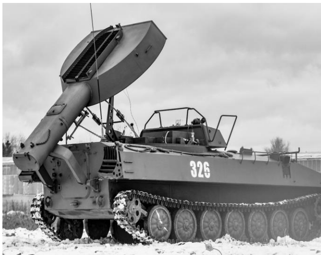
Рис.66. Установки розмінування: а – установка розмінування УР-77, б – установка розмінування УР-83П
