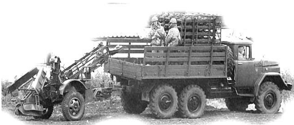
Рис. 48. Причепний мінний загороджувач ПМЗ – 4
