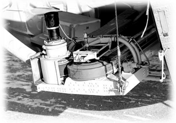
Рис. 49. Вертоліт Мі – 8МТ з розкладником ВМР – 2
