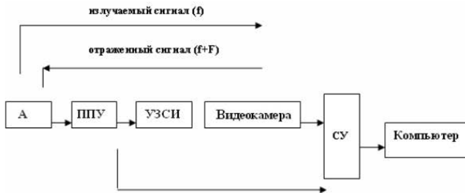
Рис. 2. Структурная схема радиолокационной установки для получения звуковой срочной информации о скорости разгона легкоатлетических снарядов
