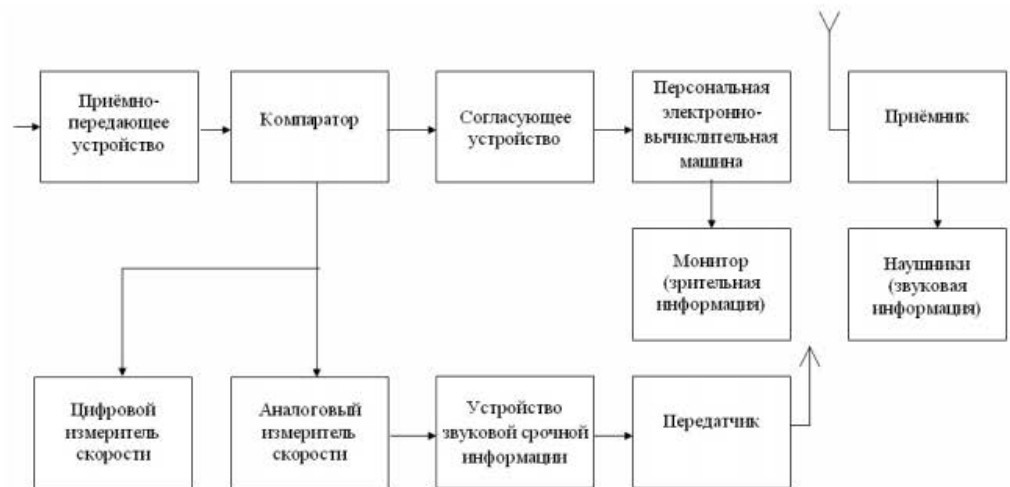
Рис. 1. Функциональная схема радиолокационной системы регистрации скорости бега со звуковой и зрительной срочной информацией
