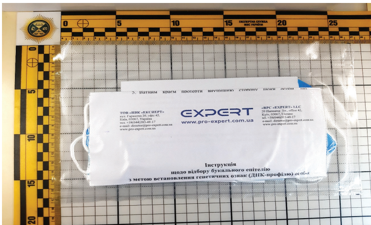
Рис. 129. Набір для відбору зразків біологічного матеріалу особи (містить одноразову маску й рукавички, серветки спиртові, два стерильні зонд-тампони, паперовий конверт та інструкцію із застосування)
