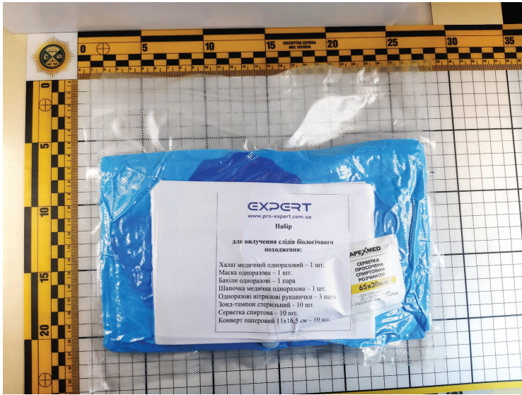
Рис. 128. Набір для вилучення слідів біологічного походження (містить одноразові халат, маску, бахіли, рукавички, стерильні зонд-тампони, серветки спиртові й паперові конверти)
