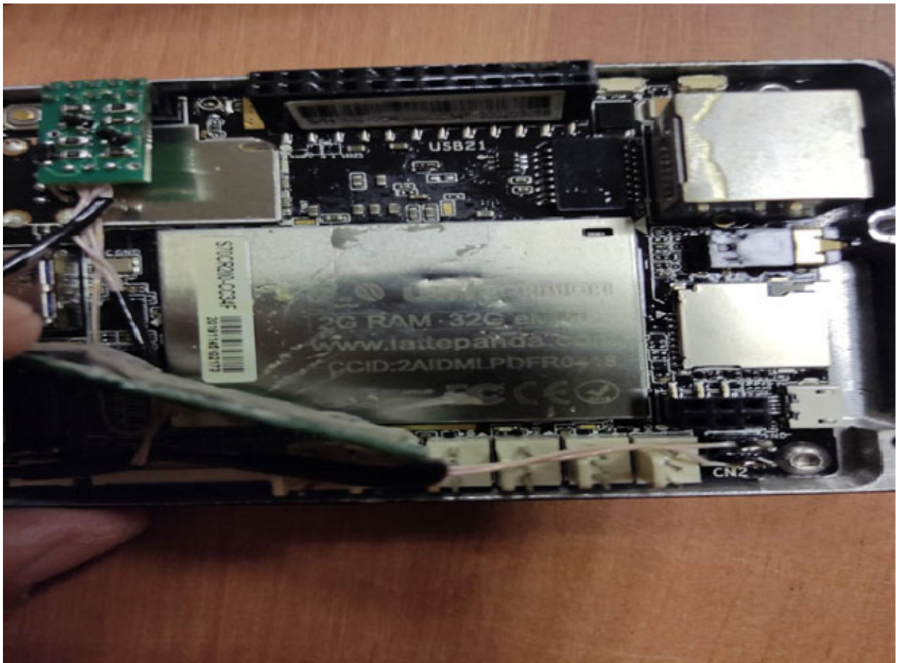
Рис. 187. Міні-комп'ютер LattePanda - зворотна сторона
