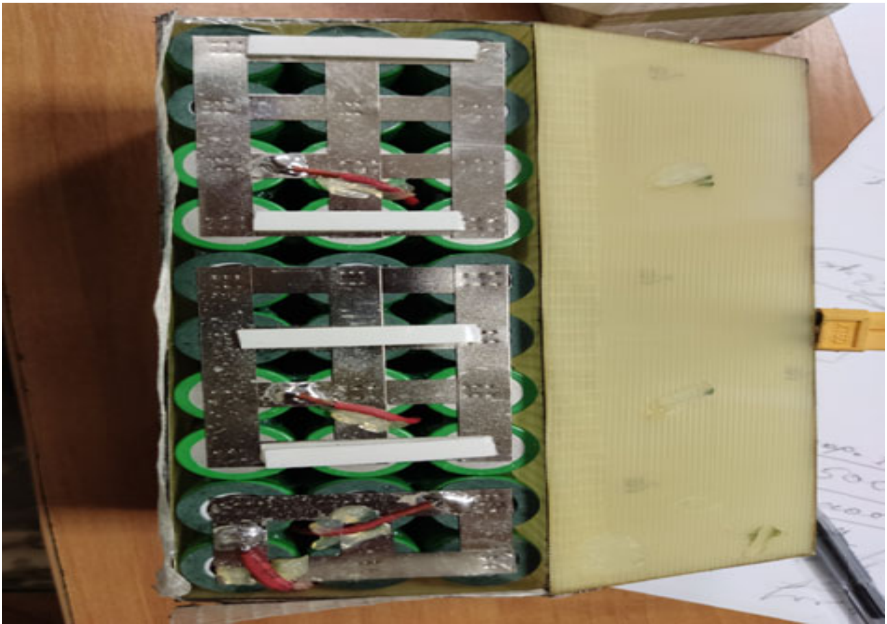
Рис. 169. Блоки акумуляторних елементів LG INR18650MJ1
