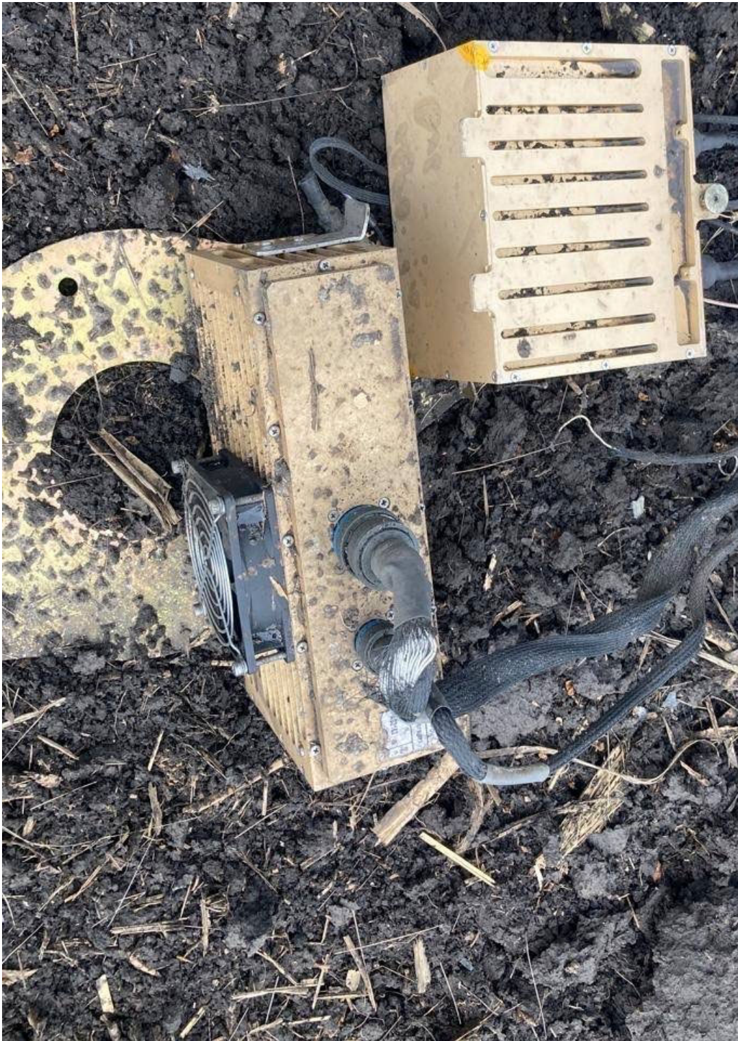
Рис. 19. Блок розподілу живлення Power Distribution Unit (PDU) БпЛА "Shahed-131" (Герань-1)
