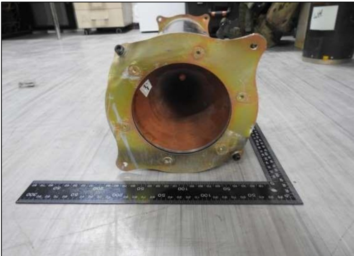
Рис. 9. Боєголовка з мідним корпусом для формуючого заряду
