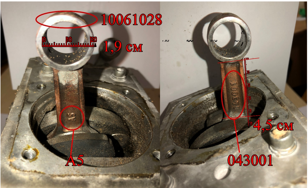
Рис. 66. Вигляд на шатун двигуна
