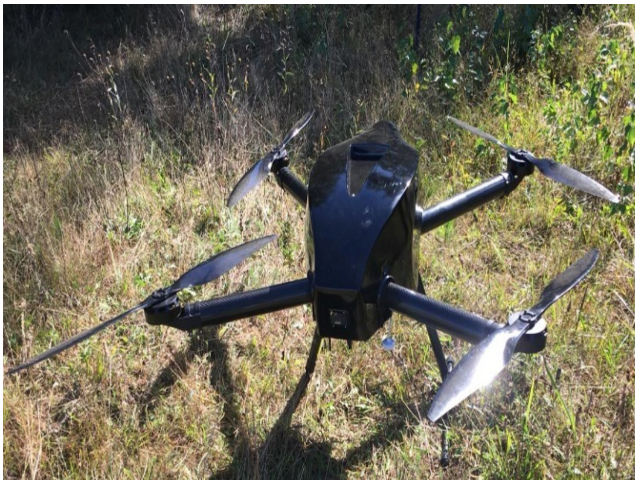
Рис. 226. БПЛА “Нелк – В4-ДВС” типу квадрокоптер з гібридним живленням
