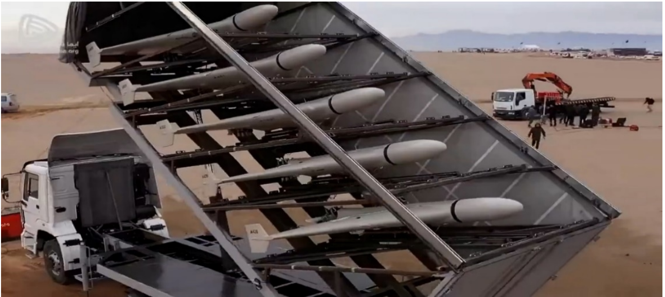
Рис. 40. Пускова установка БПЛА "Shahed-136"
