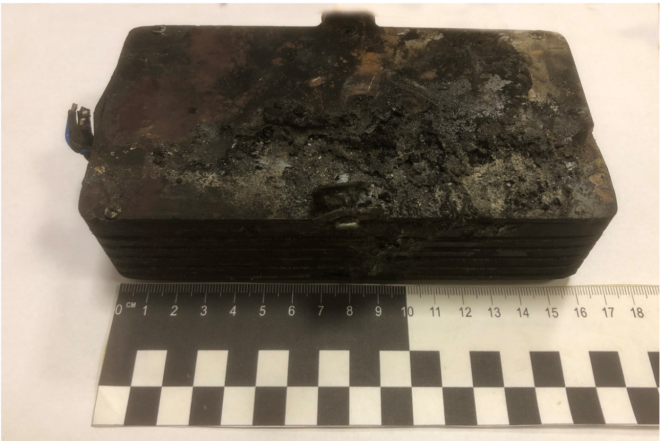
Рис. 44. Корпус імпульсного модулю, нижня частина
