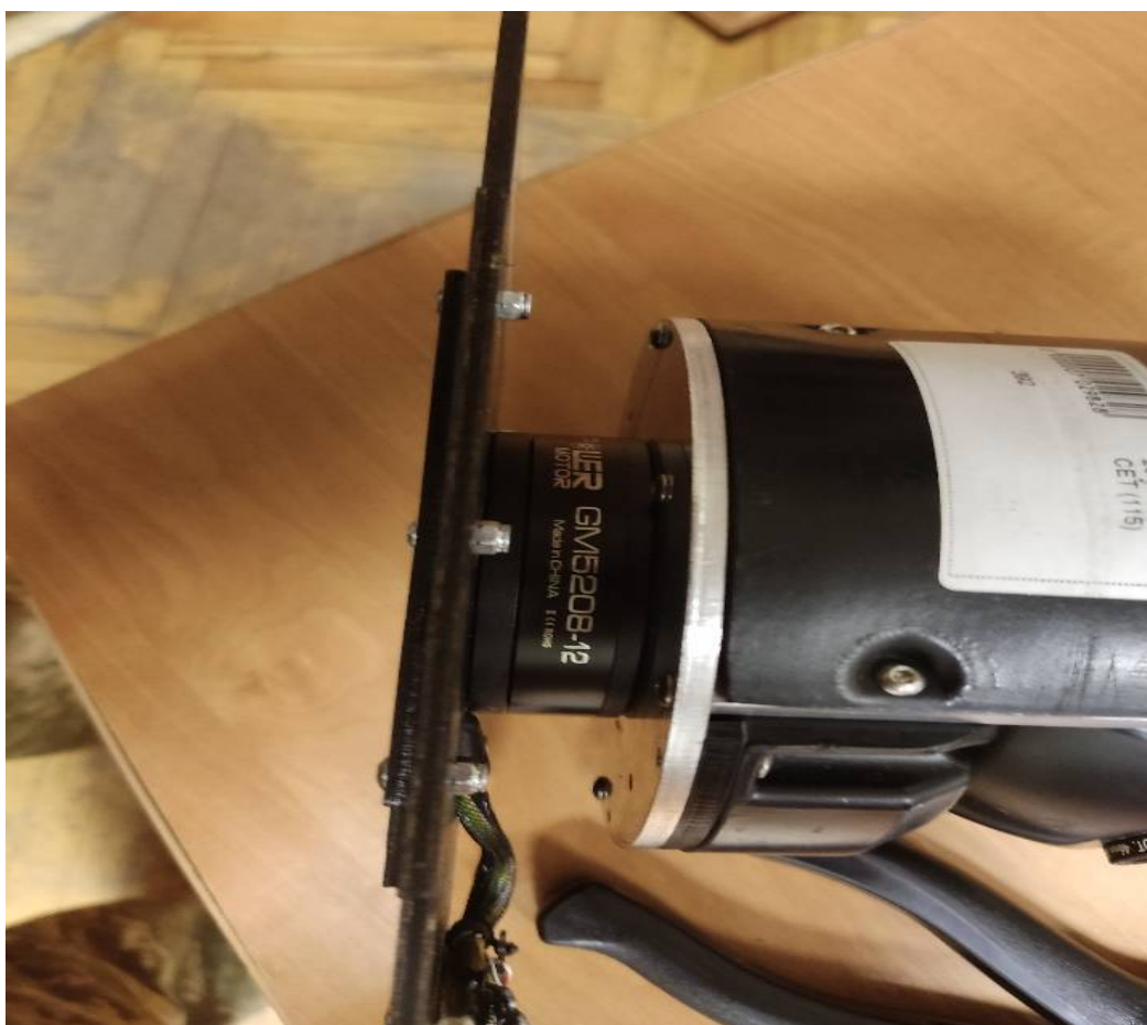
Рис. 175. Зовнішній вигляд двигуна GM5208-12
