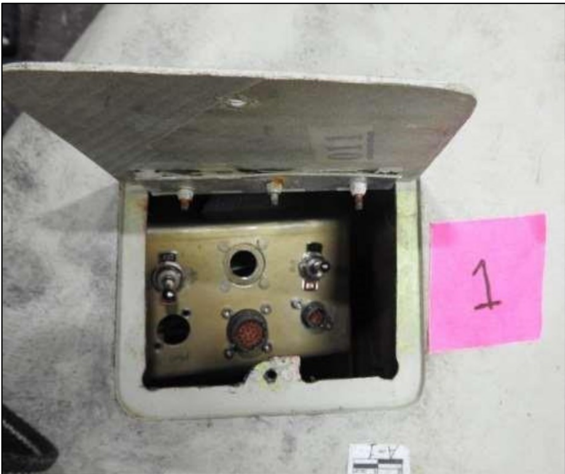
Рис. 11. Панель № 1 містить Пристрій блоку живлення БПЛА "Shahed-131" (Герань-1)
