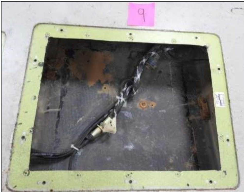
Рис. 29. Панель № 9 містить дротові з'єднувачі
