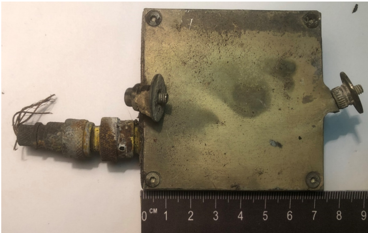
Рис. 50. Блок невідомого призначення - корпус розмірами 7x7x2.7 см з кришкою
