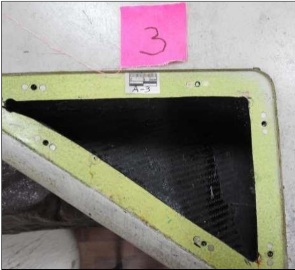
Рис. 14. Панель № 3 - Порожина в корпусі БПЛА "Shahed-131" (Герань-1)
