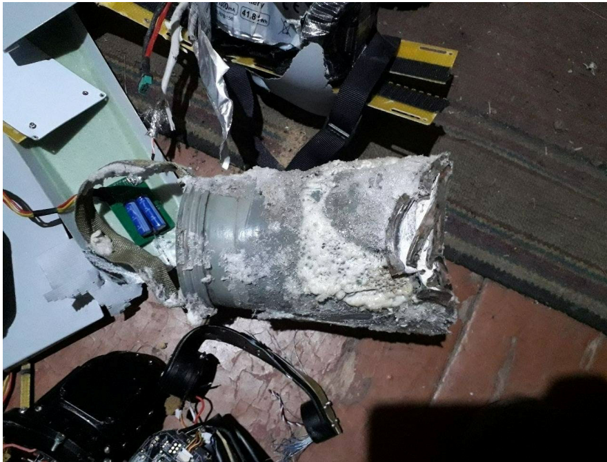
Рис. 138. Фрагменти БПЛА "Ланцет-3"
