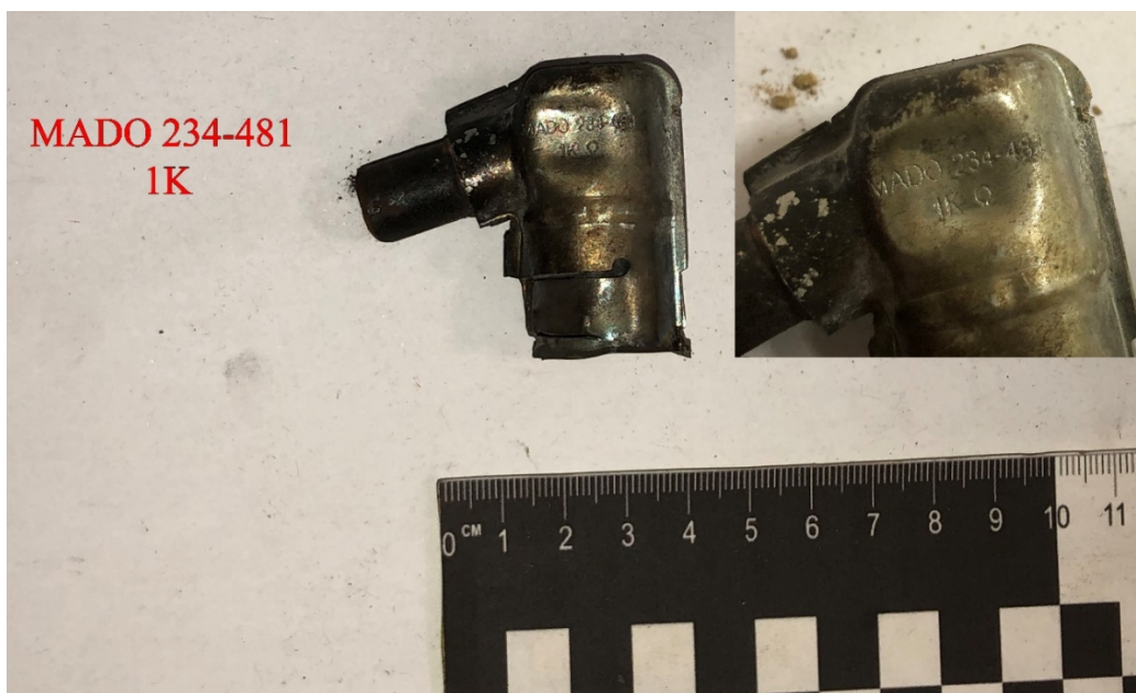
Рис. 60. Насвічник двигуна фірма виробник Mado
