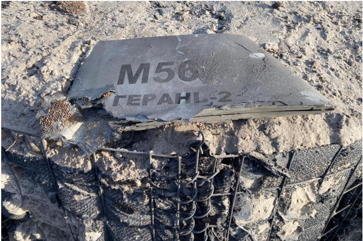
Рис. 85. Фрагмент крила БПЛА "Shahed-136" Герань-2
