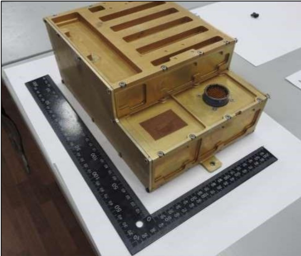
Рис. 16. Блок керування польотом FCU БпЛА "Shahed-131" (Герань-1)
