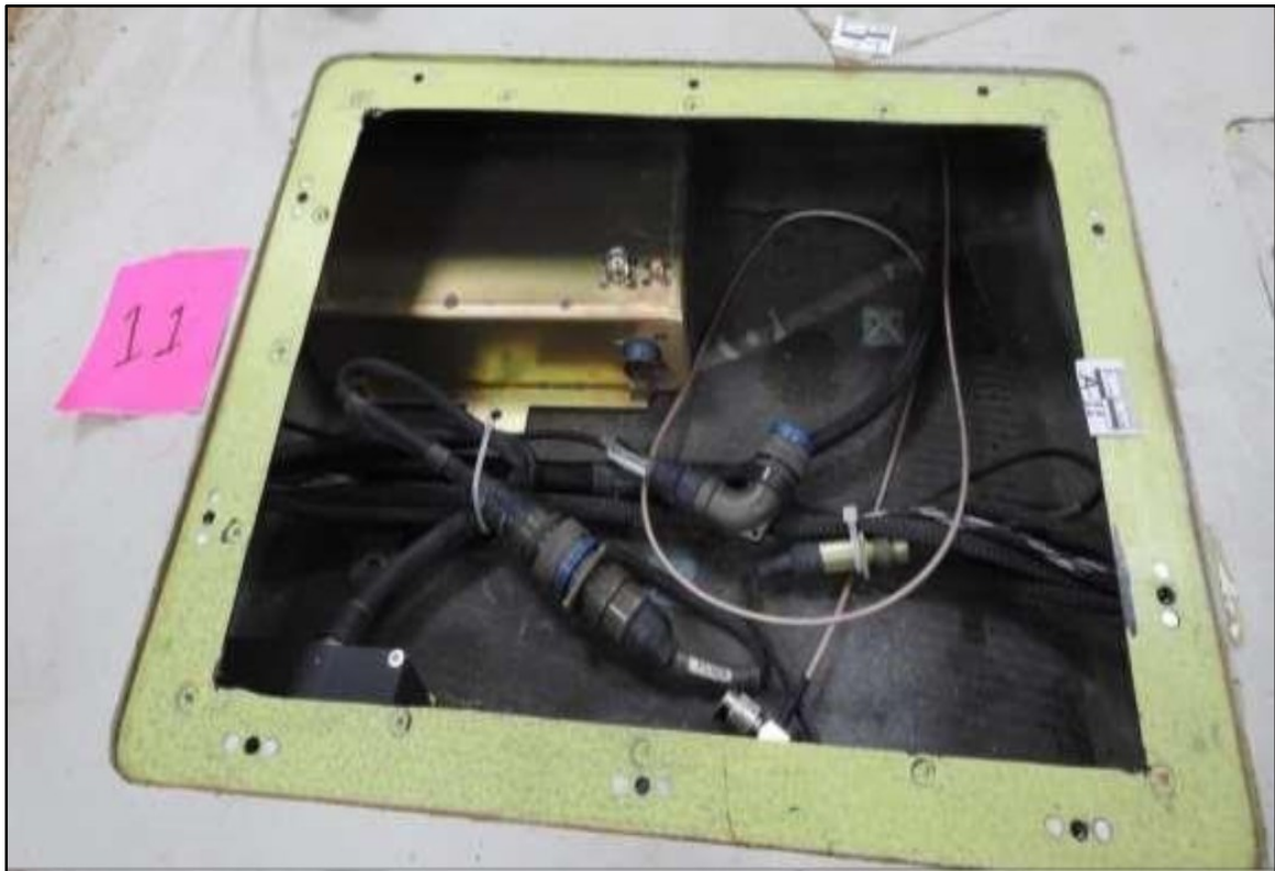
Рис. 31. Система "Автоматичний зліт та посадка" ("Automatic take off and landing" - ATOL)
