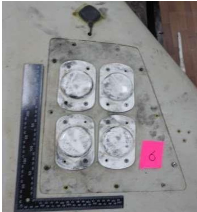
Рис. 22. Панель № 6 – Кришка трансивера системи навігації (GNSS rucks) БПЛА “Shahed-131” (Герань-1)
