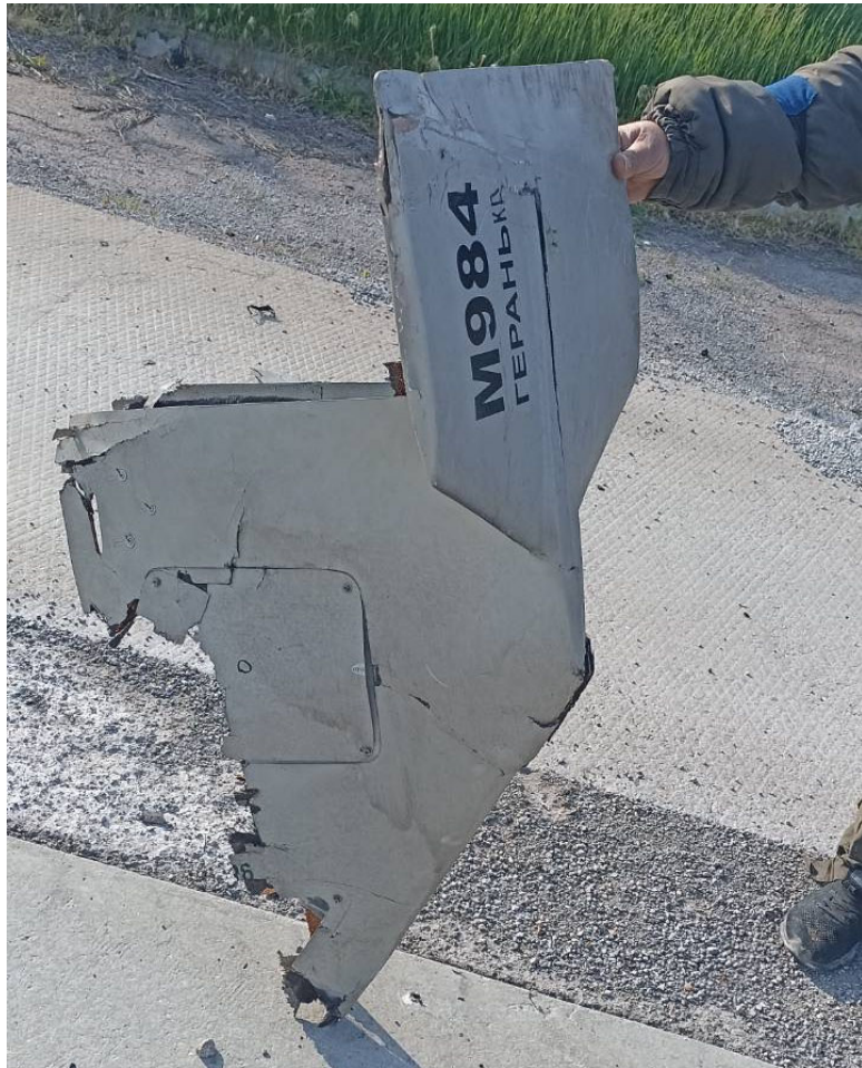
Рис. 83. Фрагмент крила БПЛА "Shahed-136" (Герань-2)
