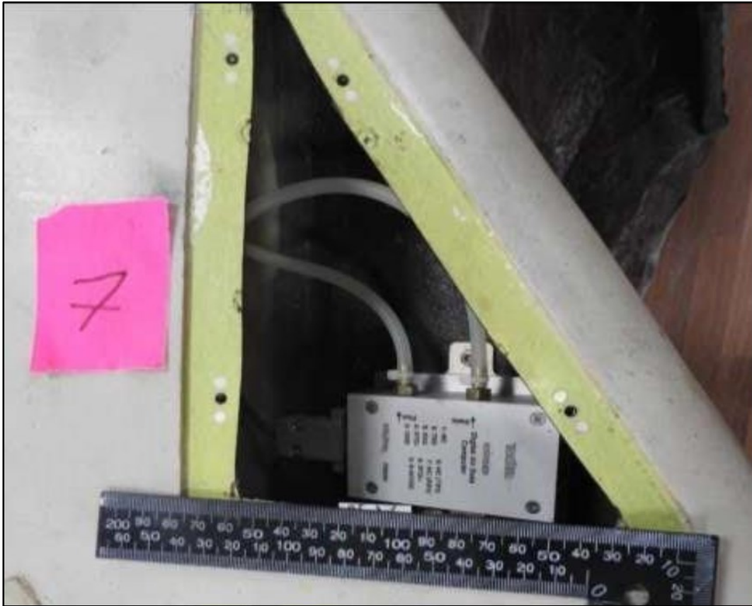
Рис. 27. Блок вимірювання інерції Interia Measurement Unit (IMU)
