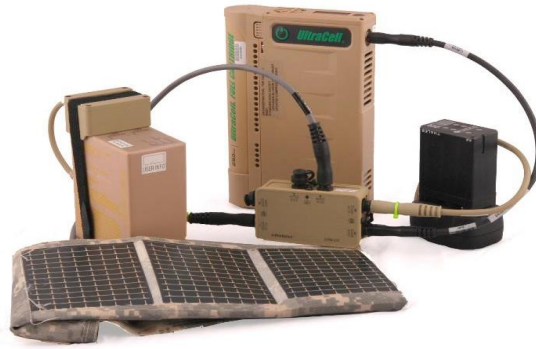
Рис. 5. Система енергопостачання відділення Squad Power Manager 611 зі складу системи Nett Warrior, Джерело: [10].
