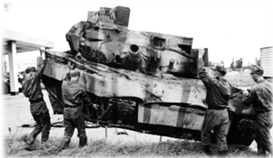
Рис. 78. Плоский макет (фотомакет) танка Т-72 (рф)
