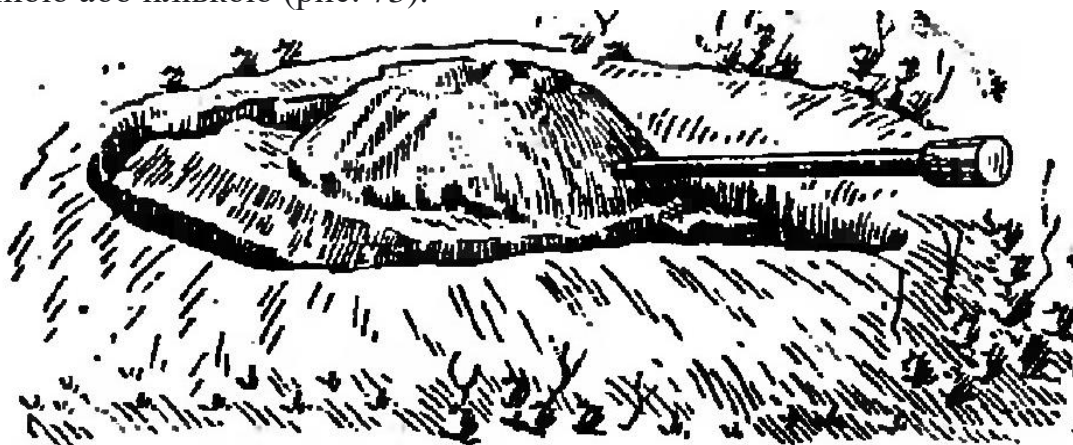
Рис. 73. Хибна споруда танка в окопі, яка виконана з ґрунту (варіант)
