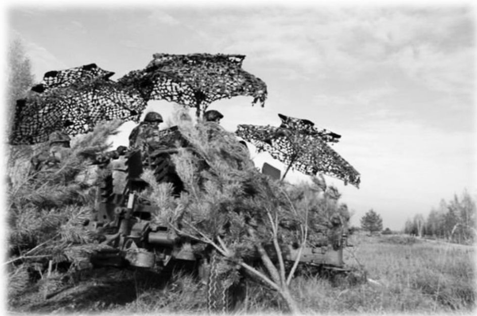
Рис.37. Встановлені елементи маски “Зонт-1” (фото)
