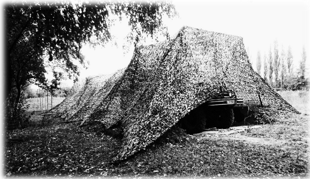
Рис. 35. Універсальна каркасна маска УМК (фото)
