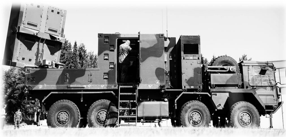
Рис. 65. Радіолокаційна станція СОВРА, яка пофарбована триколірним камуфляжем (ФРН)
