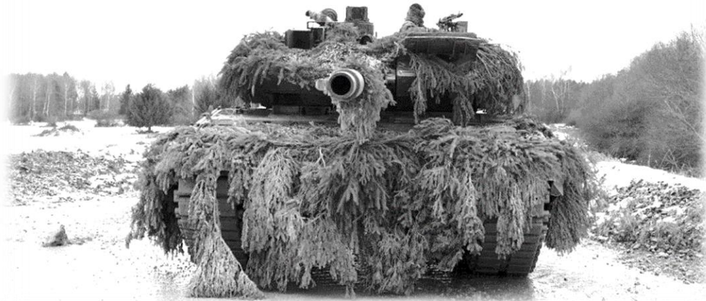
Рис.51. Маскування танка Леопард – 2 зрізаною рослинністю (ФРН)
