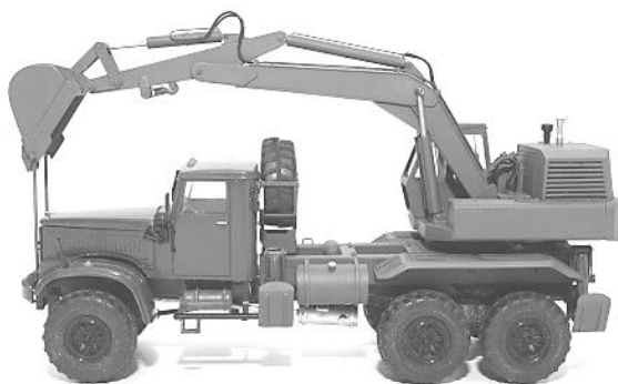
Рис. 47. Військовий гідравлічний одноківшевий екскаватор ЕОВ-4421
