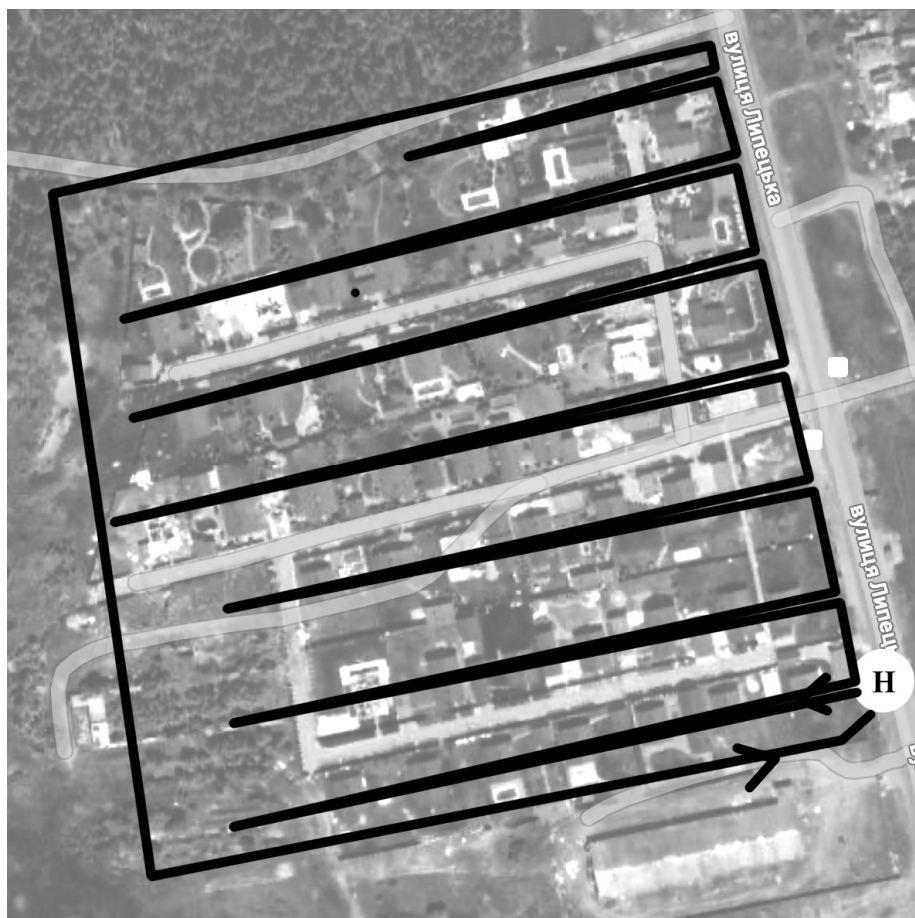
Рис. 28. Обліт плоских ділянок місцевості "гребінцем".
