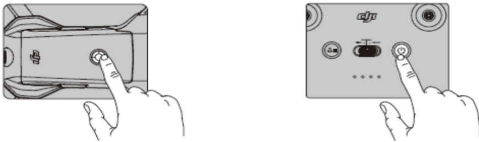
Рис. 15. Кнопки вмикання смарт-батареї та пульта дрону.
