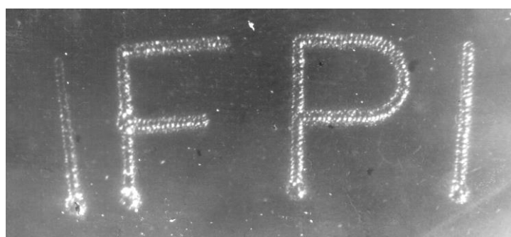
Рис. Б.2.7 та Б.2.8. Код IFPI, виконаний за допомогою лазерного променя, на окантовці робочій поверхні „чистого” диску, що призначений для запису (Рис. Б.2.7 - фотознімок з масштабною лінійкою, Рис. Б.2.8 - зображення маркування зі збільшенням 21х)
