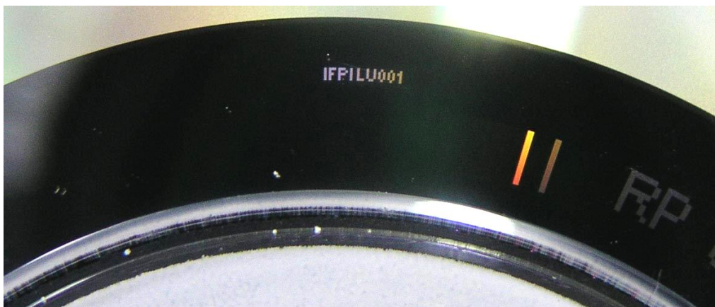
Рис. Б.2.5. SID-код на окантовці робочої поверхні ліцензійного компакт-диску
