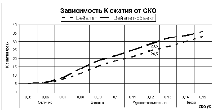
Рис. 9. Зависимость коэффициента сжатия (К сж) от среднеквадратической ошибки (СКО) при вейвлет анализе изображения.
