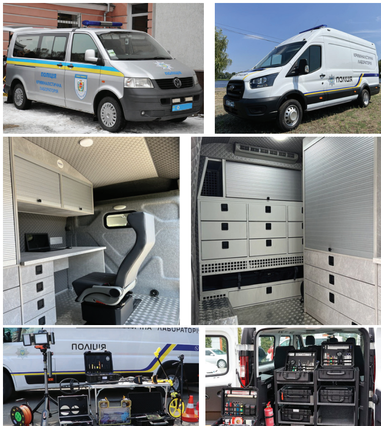
Рис. 16. Пересувна криміналістична лабораторія на базі автомобілів «Volkswagen Transporter», «Volkswagen Crafter», «Renault Master», «Fiat Ducato», «Ford Transit» (виробники – «POLYCAR», НБК «Експерт» та ін.)
