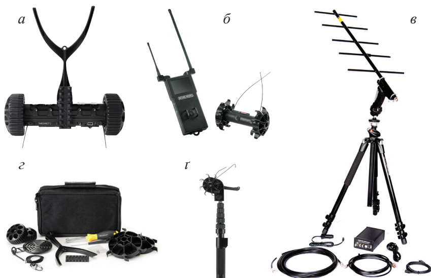
Рис. 20. Метальний комплекс «Throwbot 2»: а – робот «Throwbot 2»; б – блок керування OCU II; в – командна станція моніторингу 2.0; з – кейс і додаткове спорядження; г – телескопічна штанга (виробник – ReconRobotics, США)
