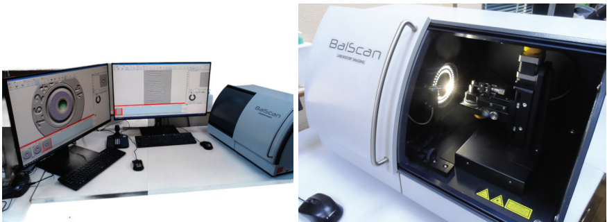
Рис. 11. Комплексна система балістичної ідентифікації «BalScan»
