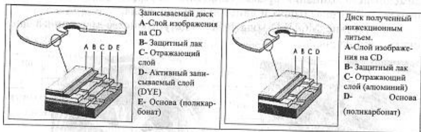
Рис. 7. Строение CD-R дисков и штампованных дисков 1
