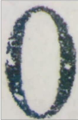
Рис. 3. Загальний вигляд знаку з відшаруваннями фрагментів тонера лазерного принтера після прасування документа праскою при температурі 150° С протягом 5 хв. (збільшення 100х).
