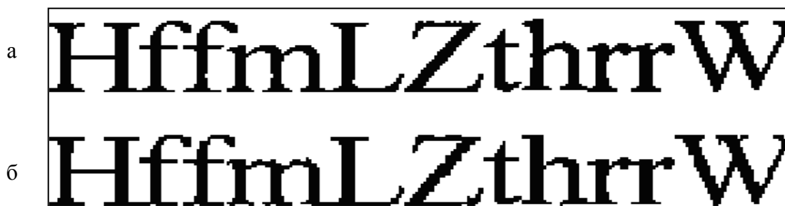
Рис. 27.6. Изображение фрагмента словаря для изображения текста 300 dpi: вверху – словарь до сжатия; внизу – восстановленный словарь
